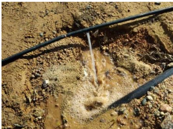
Parque Italiano Aviso EUC rotura (0,5 ml PE Ø16 y 2 enlaces)
