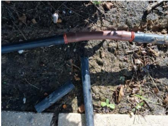
Vial ppal. margen izq. (9 roturas en PE Ø16 - tubería y 2 enlaces)
