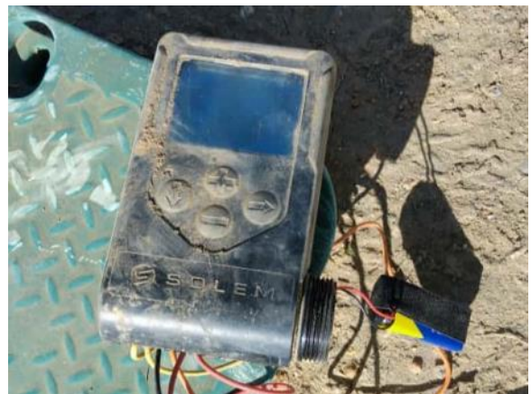
Vial ppal. margen izq. (cambio de pila)
